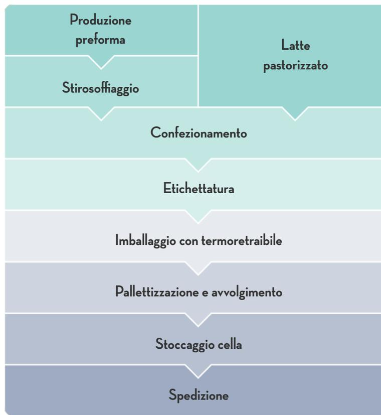
FIGURA 3 – IL PROCESSO DI CONFEZIONAMENTO DEL LATTE IN BOTTIGLIE DI PET.
