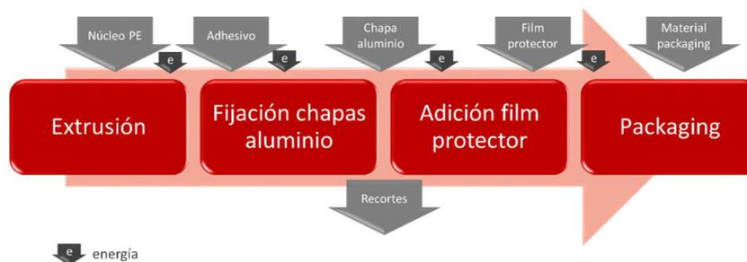
**Figura 6.** Proceso de fabricación del panel STACBOND®A2
